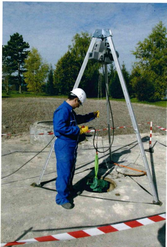
Der Minifor™ ist eine gute Alternative zu einer Handseilwinde, die oftmals in Kombination mit einem Dreibaum verwendet wird.
